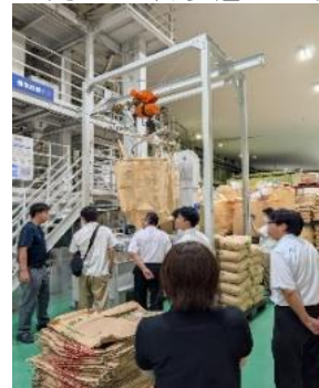
低温製法米の製造ラインでは米の酸化を防ぐために室温を15℃以下に保っています
